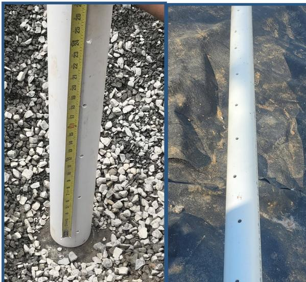
**Fotos del pozo de observación perforado, del drenaje inferior perforado (si se requiere) y de la conexión del alcantarillado pluvial (si se requiere)**
