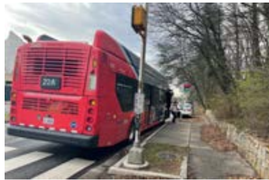
Las extensiones de banquetas en el carril de estacionamiento sirven como paradas de autobús y acortan la distancia de cruce.
